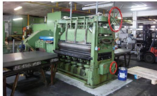
La **perforazione** provoca all'interno della lamiera forata alcune tensioni che ne possono compromettere la planarità, è quindi sempre necessario sottoporla ad una operazione di spianatura.
